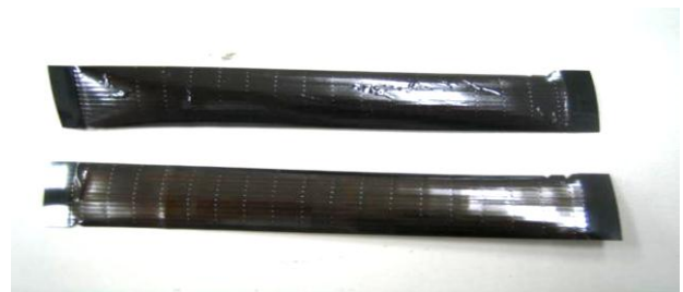
ポリイミドFPC 試験後(接着剤のひび割れ発生)
