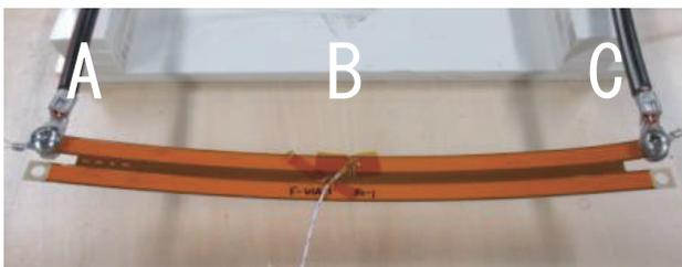
測定条件: 空中で試料に電流を印加、30分後の温度を測定
