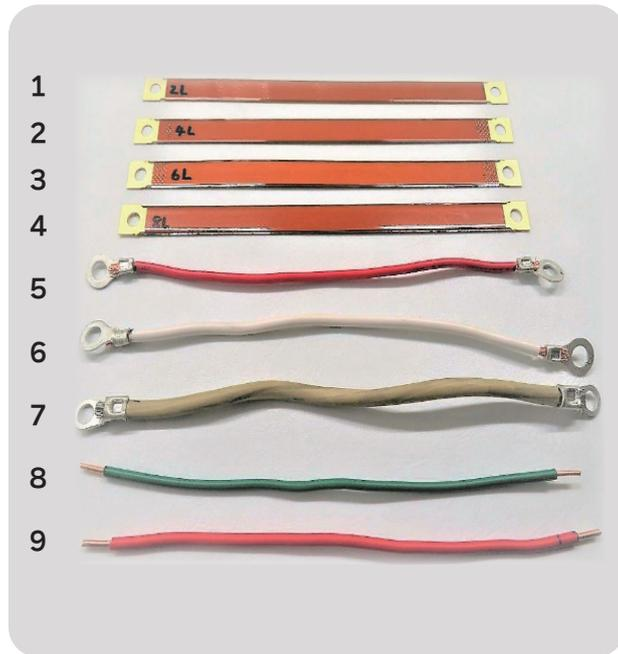
交流信号を周波数 50Hz ~ 110MHz まで連続的に変化させ、その時のインダクタンス(H)の値を計測。
